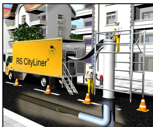
Figure 3 : Installation avec colonne d'eau
