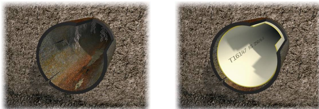
Figure 1 : Canalisation d'eau usée avant et après la réhabilitation
